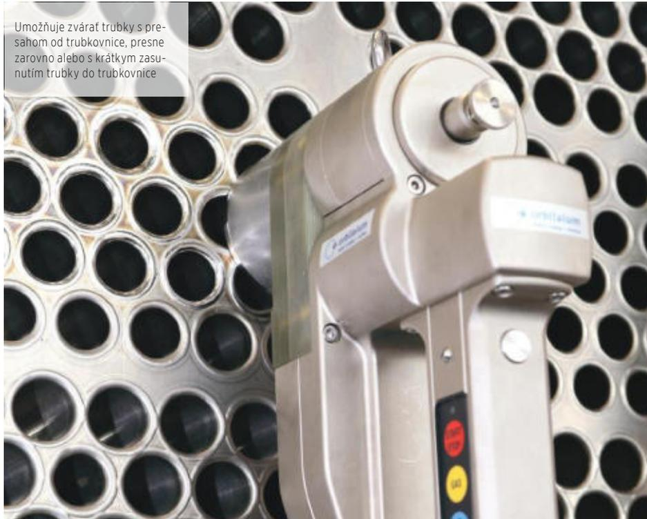
Umožňuje zvärať trubky s presahom od trubkovnice, presne zároveň alebo s krátkym zasunutím trubky do trubkovnice
