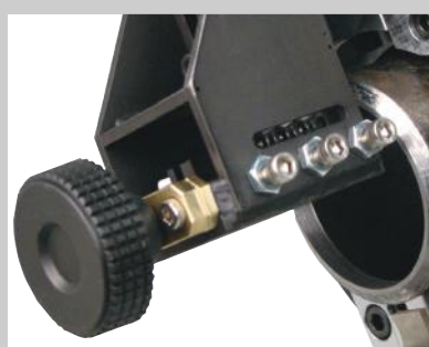
Držiak pre vnútornú kalibráciu trubiek je zhodný pre všetky modely. Bezpečné upnutie držiaku nástroja
