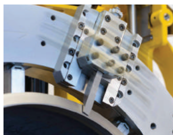
Systém elektrického pohonu EPD (Electric Power Drive) je určený pre pohon strojov WACHS LCSF (prstencový s vonkajším uchytávaním) a EP 424 (opracovanie koncov trubiek s vnútorným uchytávaním)
