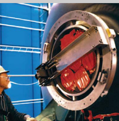
Zvláštne príslušenstvo „môstkový nožový suport“ pre veľmi hrubé steny. Úkos, dvojitý úkos a tvar U.
