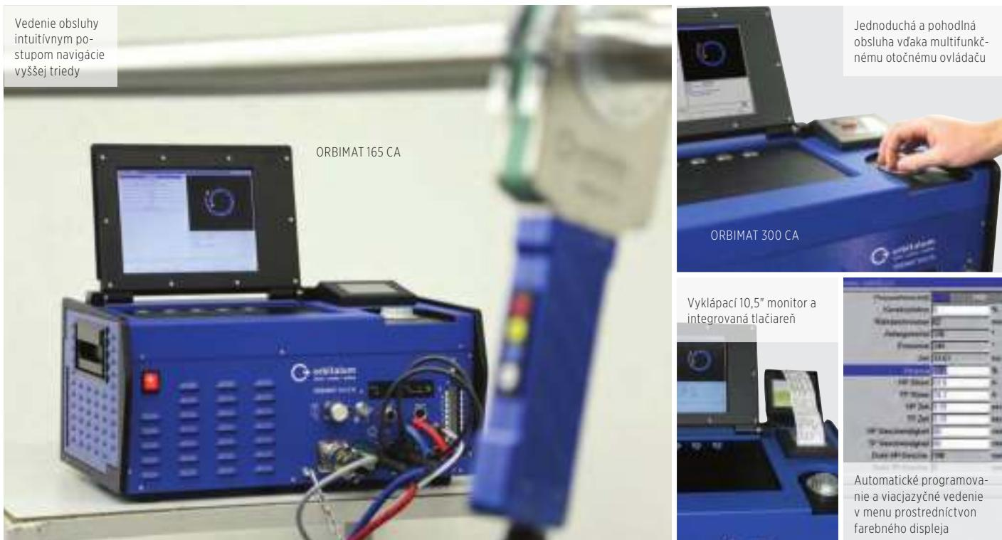
**Popri osvedčenému automatickému programovaniu, ktoré vytvoria parametre pre zváranie zo zadaneho priemeru trubky, hrúbky steny trubky a plynu pre zváranie, disponujú modely ORBIMAT CA funkciou "Flow Force" pre zníženie času počiatočného vyplachovania v uzavretých zváracích hlavách a taktiež s možnosťou pripojenia prídavného zariadenia "BUP Control" určeného pre nastavenie tlaku formovacieho plynu.**
