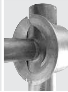
Uchyťavacie čeluste pre T-kusy s možnosťou uchytenia hrdla a konca zváranaj trubky
