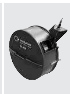
Podávač prídavného drôtu DVR (dodatočné vybavenie) pre zváranie s prídavným drôtom spolu s pohonom a nastavovacím držiakom
