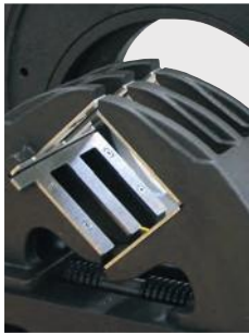
Ocelové uchytávacie čeluste a vložky z nehrdzavejúcej ocele
