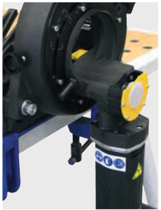
Druhá pozícia rezného kotúča pre rezanie kolien
